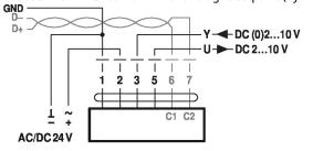
BACnet MS/TP / Modbus RTU
