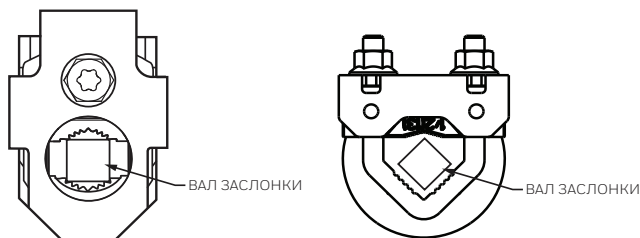
Рис. 8. Правильная установка на квадратный вал заслонки.
